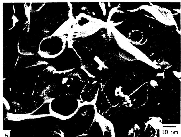
Fig. 5 - Aspecto da fratura na região de clivagem. Esta é a morfologia característica da menor parte da fratura.
